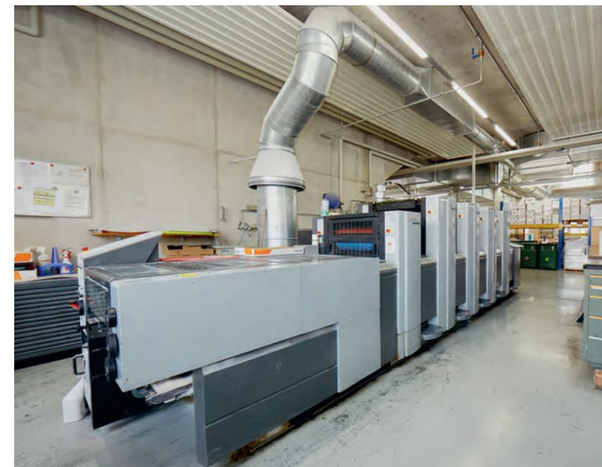
Auch die Speedmaster SX 52-4+L ist während 24 Stunden am Tag ausgelastet. Sie verarbeitet Aufträge, die direkt aus einer Vielzahl an B2B-Shops kommen. Auf der Maschine werden unter anderem mehr als zehn Millionen Kuverts pro Jahr bedruckt.
